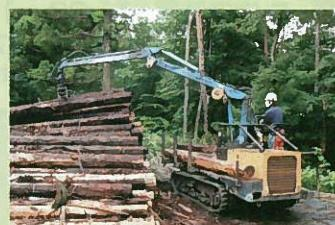
山林用の運搬車で丸太を集めます。（フォワーダによる集積）
