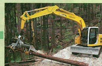
専用の重機を使って切った木の枝を払い、その幹を一定の長さで切って丸太にします。
