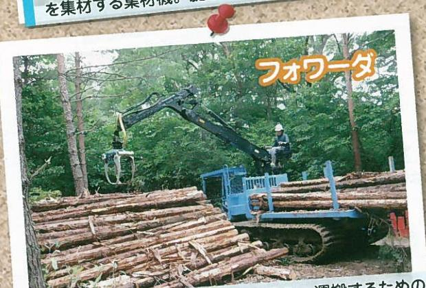
フォワーダは丸太を荷台に積み込み、運搬するための丸太の積み下ろしのためにグラップル集材用車両。丸太の積み下ろしのためにグラップルローダーを装備している。
