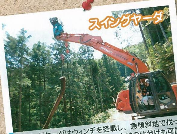
スイングヤーダはワインチを搭載し、急傾斜地で伐った木を集材する集材機。旋回可能で木材の仕分けも可能。
