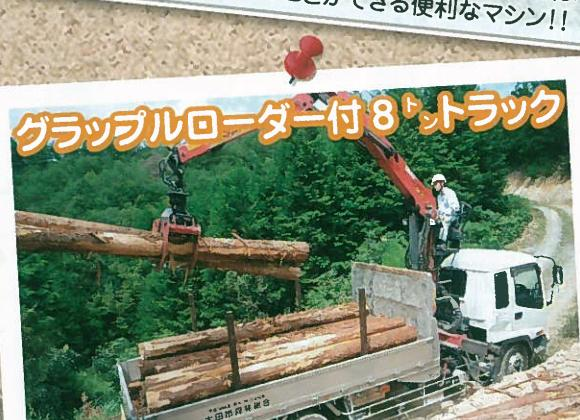
グラップルローダー付8tトラックは荷台上部に据え付けられたグラップルを使って短時間に木材の積み下ろしができる。
