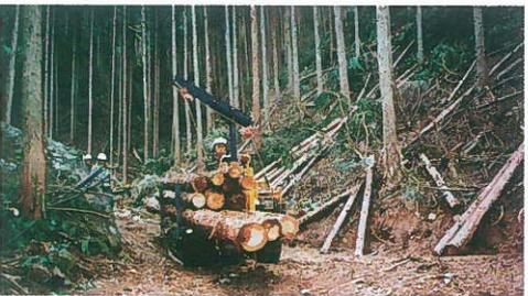
H7年頃の林内作業車での間伐搬出の様子
