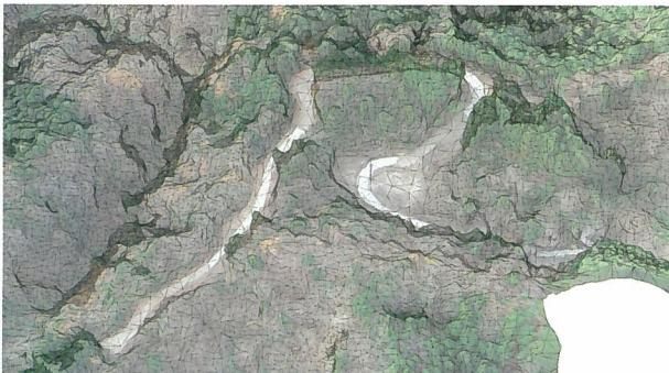
令和3年度は4路線（継続路線含む）の林業専用道（規格相当）開設を計画しております。林業専用道とは、大型トラックの通行を想定した高規格の道で、構造物等を設置し排水対策も行います。木材の搬出コストの削減に有効な道となっております。
